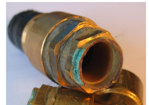
Eksempel spændingskorrosion i messingfitting
