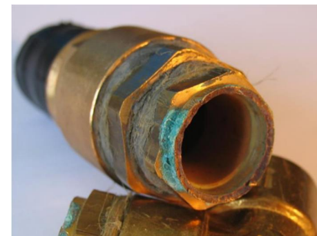
Eksempel spændingskorrosion i messingfitting
